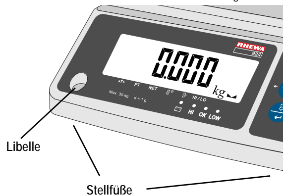
Abb. 7 Ausrichten der Waage, Libelle
