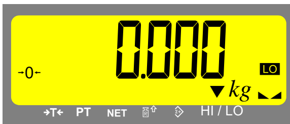
Abb. 15 Signalisierung der Sollwertkontrolle
